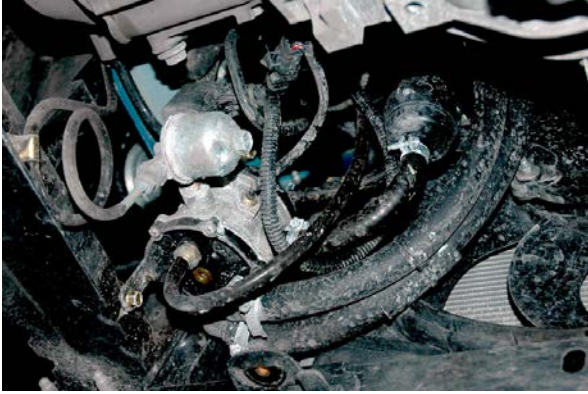
Рис. 3 Газовый редуктор с фильтром жидкой и газообразной фазы, в нижней части моторного отсека автомобиля, несмотря на использование крышки не защищен от примесей на 100%.
